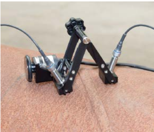
对接焊缝及环焊缝的手动扫查, 带编码器, 探头架带两个TOFD探头
